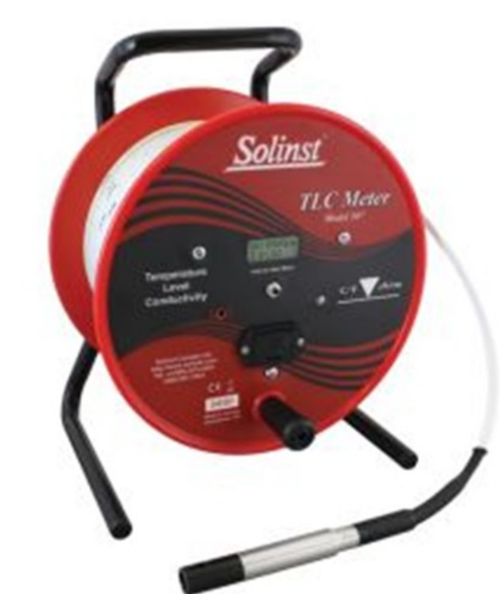
Pejling af groutoverflade
