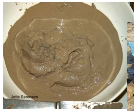
Figur 1.3c. Prøve løsboret med rullemejsel i lufthæveboring.
