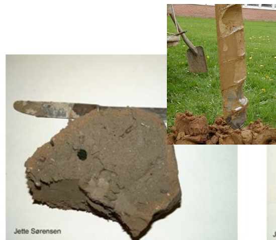
Figur 1.3a. Prøve udtaget med snegl.
