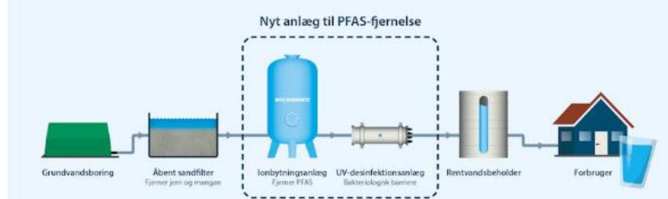
Grafik, der viser vandets vej fra boring til vandhane på Fanø, efter det nye vandbehandlingsanlæg fra Silhorko er installeret. Efter ionbytningssystemet tilføjes et UV-desinfektionsanlæg for at sikre, at drikkevandet også er komplet frit for bakterier og vira.
