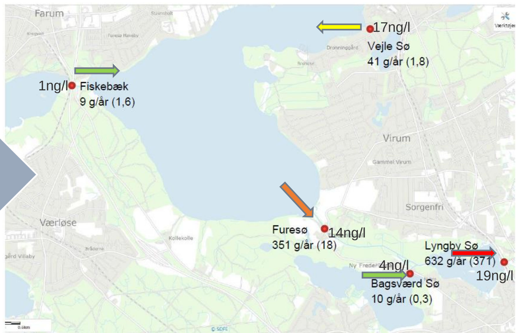
Figur 2 Placering af prøvetagningspunkter og beregnet årlig massestrøm af PFOS (g/år). Standardafvigelsen står i parentes.
