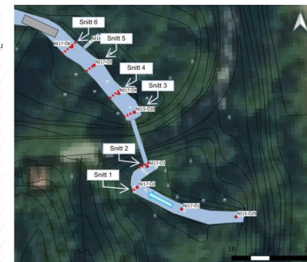
Figur 2.2: Plankarta över de sex tvärsnittens lokalisering. Resultaten redovisas i Figur 2.3. Den blå pilen uppströms Snitt 1 visar bäckens strömningsriktning.
