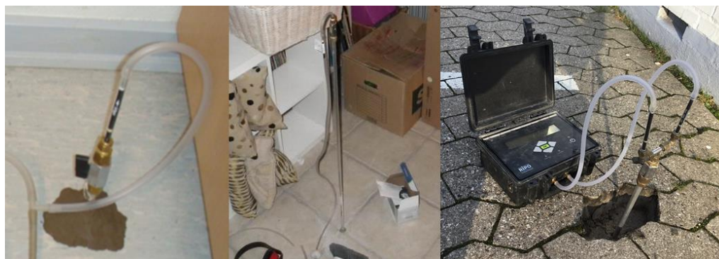
Figur 4.5 Poreluftprøvetagning med studs og spyd gennem gulv, samt spyd udendørs.
