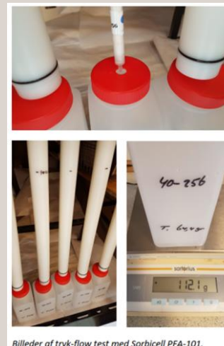
Billeder af tryk-flow test med Sorbicell PFA-101.
